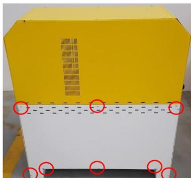
**Rimuovere le viti di fissaggio e smontare il pannello laterale**
