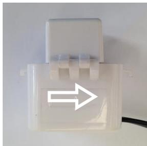
Il sensore CT misura la corrente scambiata con la rete pubblica. Posizionare (chiudere ad anello) il sensore sul cavo di FASE (marrone o nero o grigio) subito a valle del contatore (bidirezionale) della rete pubblica e con la freccia rivolta verso il contatore.
