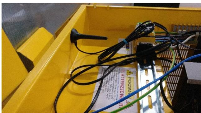
Antenna GPRS - posizionamento interno alla macchina
